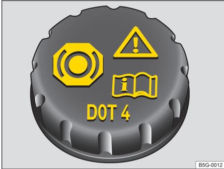
图 237 发动机舱内：制动液容器的盖子
