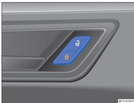
图 55 驾驶员侧车门内：中央门锁按钮
