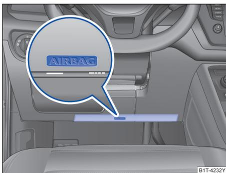
图 40 驾驶员侧：膝部安全气囊的安装位置
