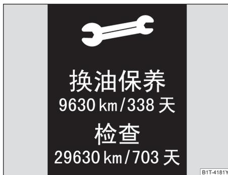
图 14 保养信息示意图：组合仪表显示屏显示示例
