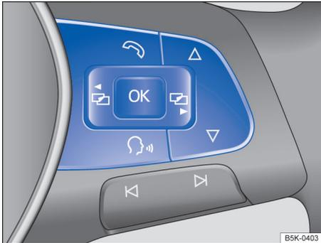
图 17 多功能方向盘右侧：用于操作信息显示器中菜单的按钮
