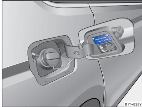
图 214 油箱加油口盖板内侧的标签
