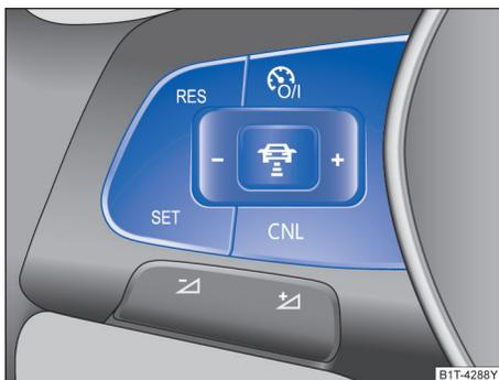
图 147 多功能方向盘左侧：自适应巡航系统（ACC）
