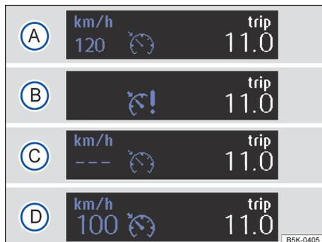
图 143 组合仪表显示屏：定速巡航系统状态显示
