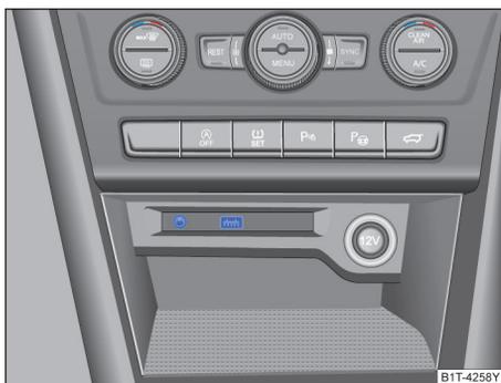
图 186 中控台内的 USB、AUX IN 输入端
