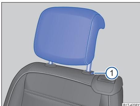
图 90 拆卸和安装后排头枕
