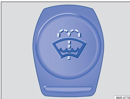
图 233 发动机舱内：车窗清洗液容器盖
