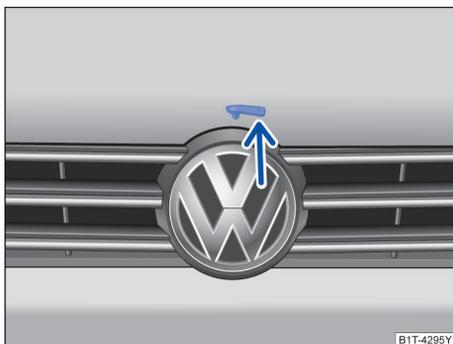
图 231 散热器格栅上方用于打开发动机舱盖的分离杆
