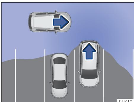
图 158 驶出车位辅助原理图：车辆驶出停车位时的车后左右两侧监控范围
