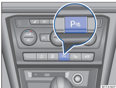
图 164 在中控台中：用于接通或关闭前后泊车雷达系统的按钮
