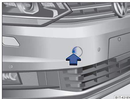
图 226 在保险杠的右前部：拆卸盖板
