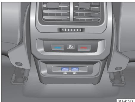
图 187 部分车型后排出口下方的 USB 输入端
