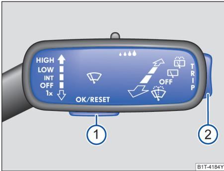
图 16 车窗玻璃刮水器操作杆：按钮①用于操作菜单项，开关②用于切换菜单
