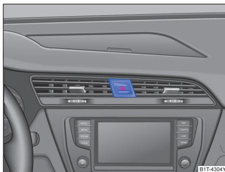
图 48 在中控台上部分中：危险警报灯开关
