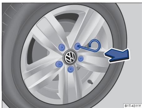
图 244 从车轮螺栓上拔下盖罩
