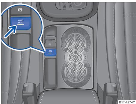
图 161 在中控台：自动驻车功能按钮
