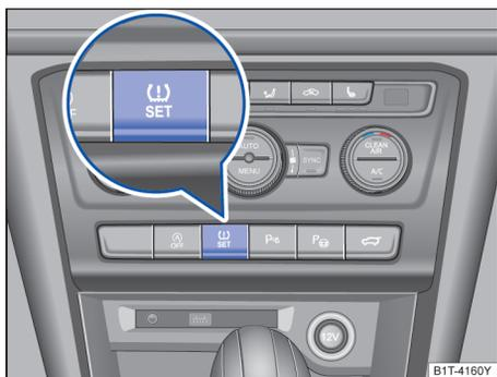
图 239 被动式轮胎气压监控系统设定按钮
