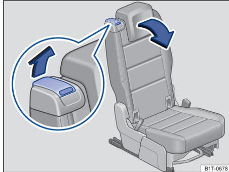
图 81 第二排座椅：上车辅助功能的操作杆
