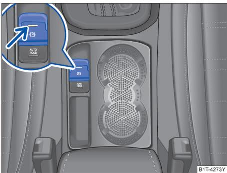
图 160 在中控台下部：电子驻车制动器按钮
