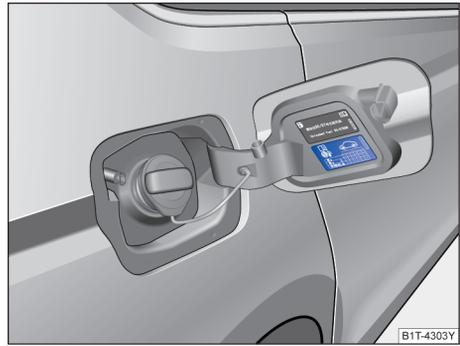
图 243 轮胎气压数据标牌（具体信息请参考实车标牌）
